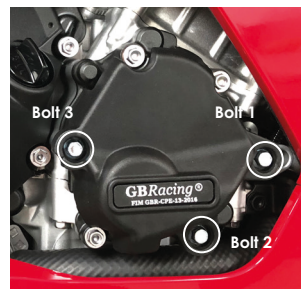
Bolt 3 M6X35HHF - 10Nm
